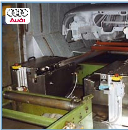
Skid Reinigungseinheit Skid cleaning unit.
